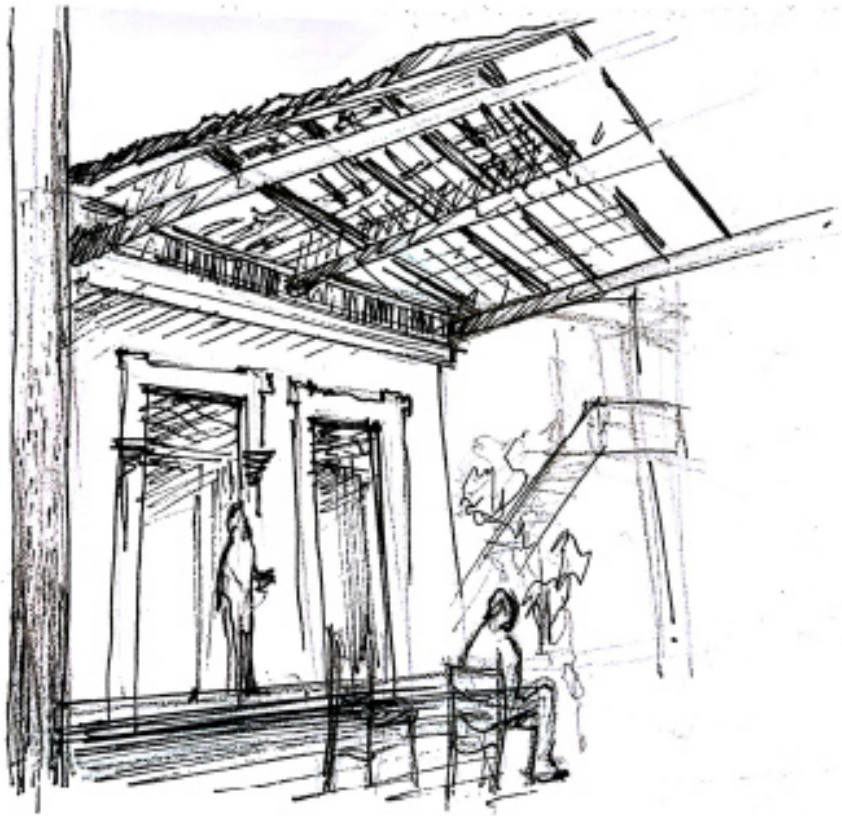
Μεταγενέστερο υλικό-Οροφή με βολίτζια σε ψάθα Οροφή με βολίτζια και σανίδια
